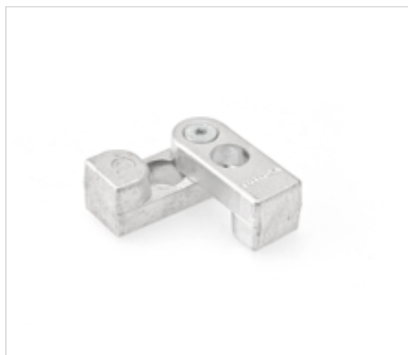
Giunto interno in alluminio ad angolazione variabile. Fissaggio con collante o viti autofilettanti.
